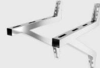
Support de base avec sortie de l'eau de condensation : Pour un montage mural, vous avez besoin de la console murale correspondante de la taille appropriée. Vous n'en avez pas besoin pour un montage au sol. Vous pouvez fixer ce support de base directement au mur à l'aide des vis mentionnées précédemment dans les ouvertures prévues à cet effet ou poser le produit au sol.
