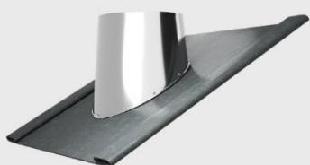
**Solin de toit en plomb :** Si vous souhaitez faire passer votre cheminée en acier inoxydable par le toit, vous avez besoin d'un solin de toit adaptée. Le produit en plomb ou en aluminium recouvre largement la traversée par laquelle le conduit de cheminée est passée. Veuillez noter que vous devez également fixer une collerette de solin sur l'élément droit au-dessus de la traversée de toit, afin d'éviter que la pluie ou la neige ne pénètre dans l'espace intermédiaire.
